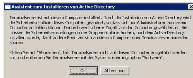
**Abbildung 3.3:** Hinweis zur Änderung der Sicherheitsrichtlinien bei Aufstufung zum Domain Controller
